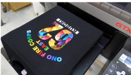
7. カラーモードでプリントします。ガーメントプリンターの白インクを使用する場合は白インクを少なくプリントして下さい
