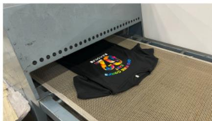
8. プリント完了後はトンネル乾燥機で乾燥か（自然乾燥の場合1時間程度放置）してプレス
